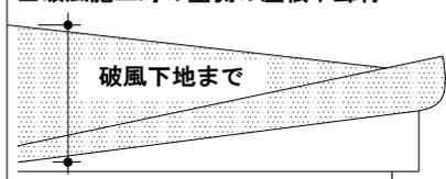
破風を施工しない場合は屋根頂部から200mm以上壁側に屋根下葺材を葺きます。
